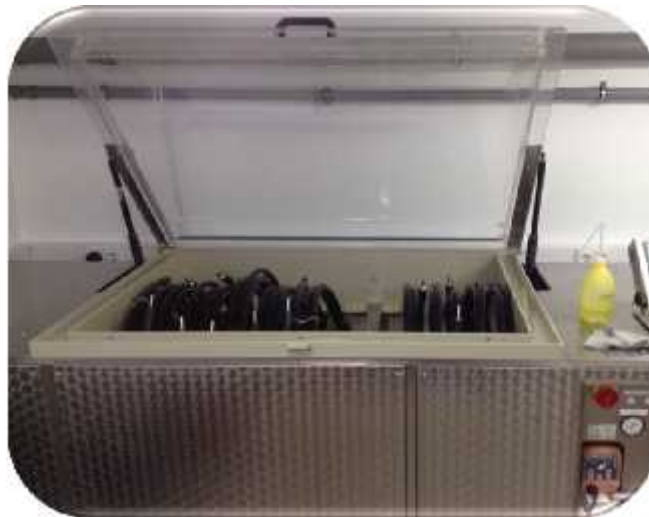
Korrosionsprüfung z.B. Halter, Anschlusselemente
