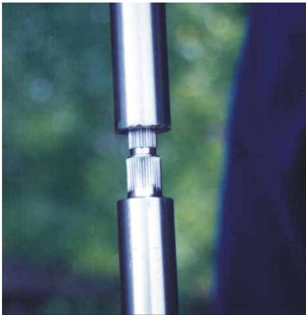
Bild 1: Kupplung eines Tiefenerders
