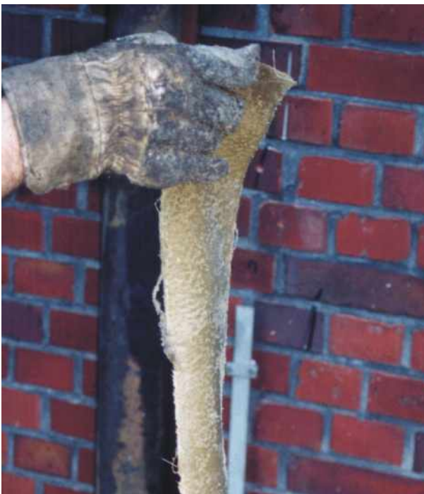
Bild 6: Fettbinde, Vaseline auf Baumwollgewebe, als Korrosionsschutz
